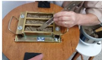
*Figura 1: Moldagem dos Corpos de Prova*
