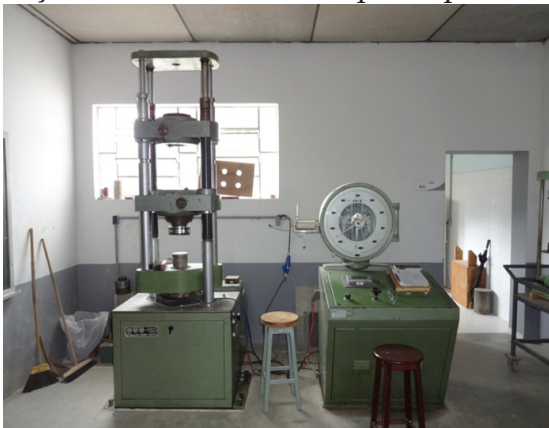
Figura 3 - Máquina universal de ensaios, utilizada para determinação da resistência à compressão uniaxial.
