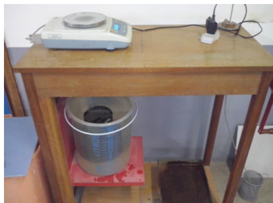
Figura 2 - Esquema para determinação das massas submersas das amostras.
