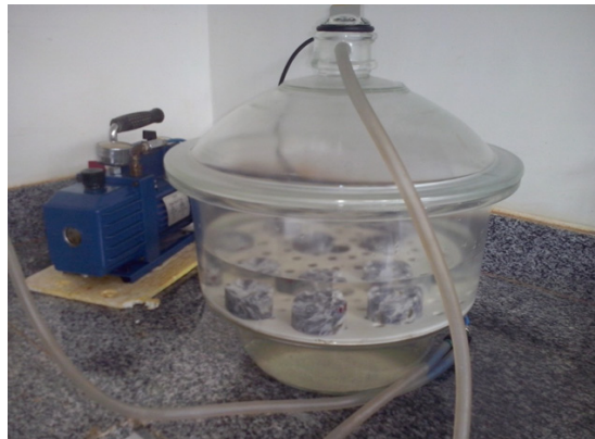
Figura 1 - Conjunto dessecador-bomba de vácuo para saturar as amostras.
