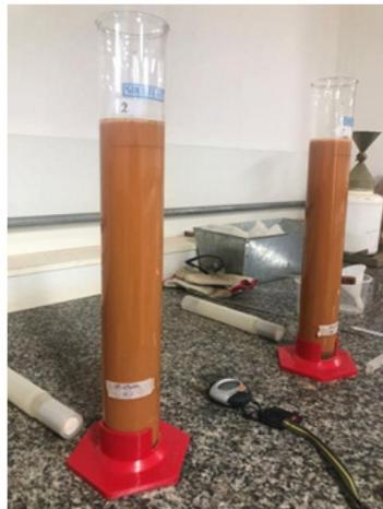
Figura 4. Amostras de solo dispersas em água destilada.
