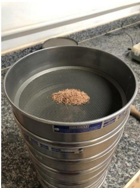
Figura 6. Ensaio de peneiramento.
