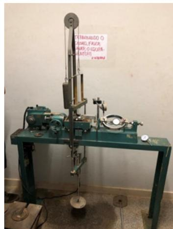
Figura 16. Aparelho para o ensaio de Resistência ao cisalhamento.
