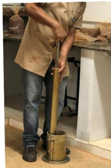
Figura 13. Ensaio de compactação Proctor.
