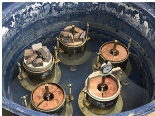
Figura 14. Amostra submersa.
