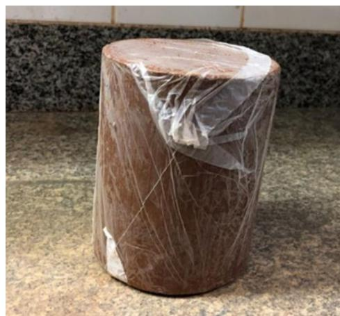
Figura 17. Corpo de prova para retirada da moldagem para o ensaio de cisalhamento
