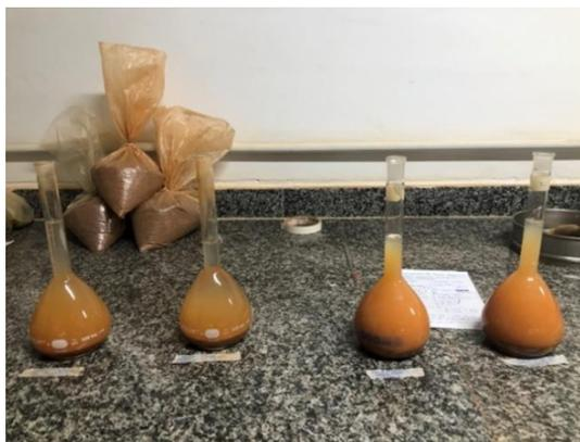
Figura 7. Ensaio de sedimentação.
