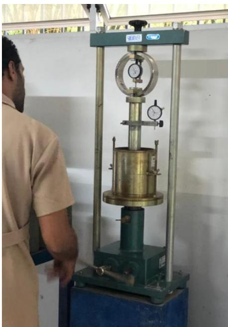
Figura 15. Ensaio com CBR.
