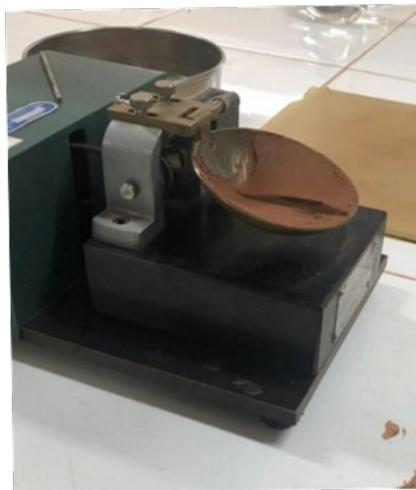
Figura 8. Ensaio com aparelho Casagrande.
