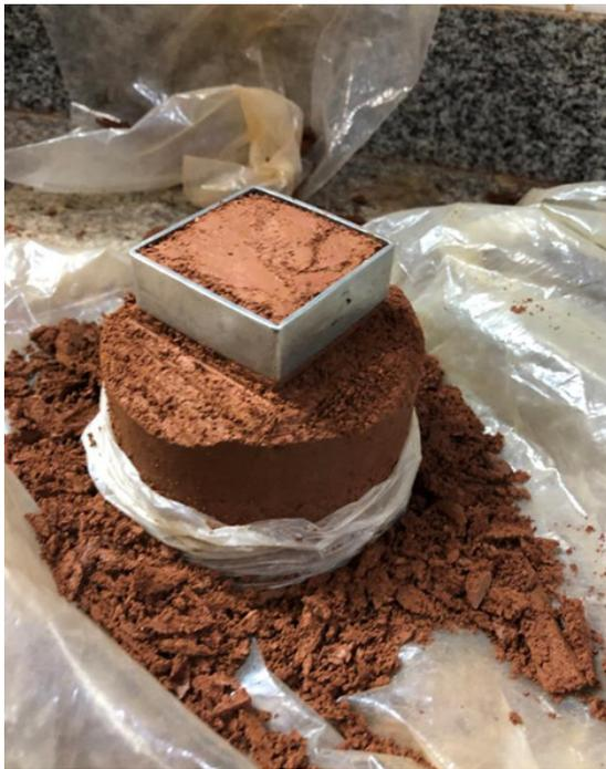
Figura 18. Moldagem do corpo de prova para o ensaio de cisalhamento
