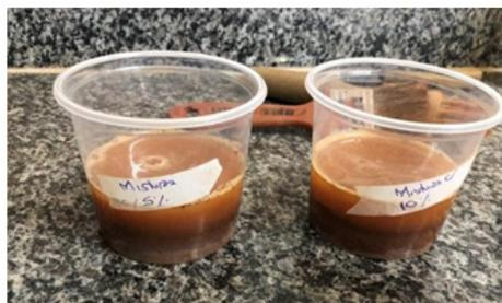
Figura 5. Ensaio de sedimentação
