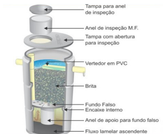
Figura 1: Filtro anaeróbio de leito fixo
