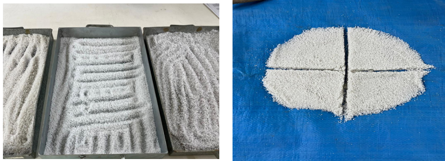
(a) (b) Figura 1- (a) Amostras de resíduo de mármore; (b) Quarteamento.
