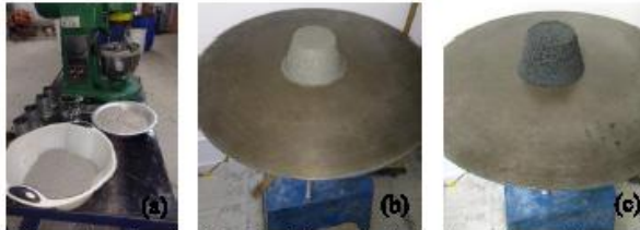
Figura 2 – Execução do ensaio para determinação do índice de desempenho da sílica da casca de arroz. (a) preparação dos quantitativos dos materiais; (b) "Argamassa A" flow table test; (c) "Argamassa B" flow table test. Fonte: Autor.
