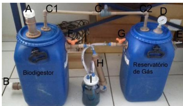
Figura 1: Biodigestor, reservatório de gás e filtros de purificação do biogás.
