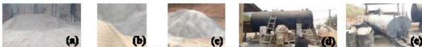
Figura 1 – Materiais para fabricação de PMF. (a) Areia lavada; (b) Brita; (c) Pó de pedra; (d) Tanque principal de armazenamento de emulsão; (e) Tanque secundário de armazenamento de emulsão.
