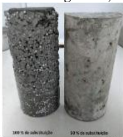
Figura 2 - Corpos de prova com substituição de 100% e 50%
