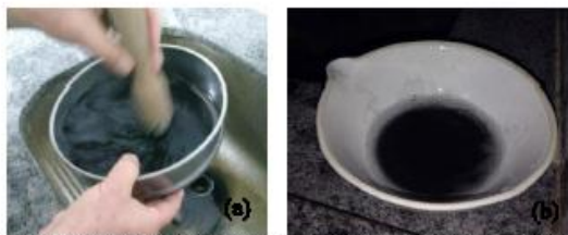
Figura 1 – Execução do ensaio de finura por lavagem. (a) lavagem da amostra em água corrente na peneira de malha 45 \mu\text{m} ; (b) resíduo retido na peneira levado para estufa para secagem. Fonte: Autor.
