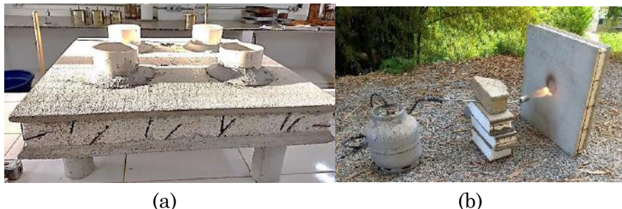
Figura 2. Ensaios de desempenho desenvolvidos no Bloco Cimento: (a) Ensaio de permeabilidade; (b) Ensaios de resistência ao fogo.
