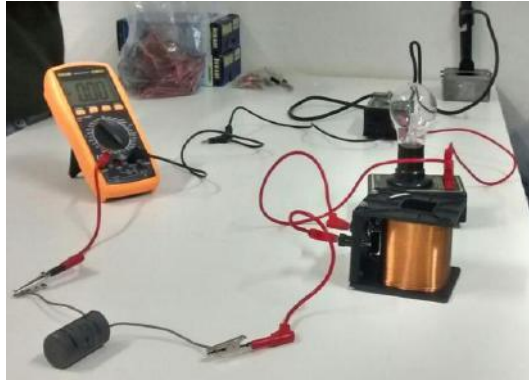
Figura 2- Circuito RLC em série. Fonte: Autor.
