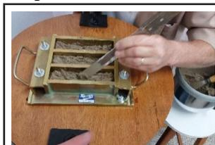
Figura 1: Moldagem dos Corpos de Prova
