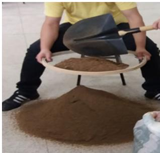
Figura 1 – Peneiramento da Areia Coletada.
