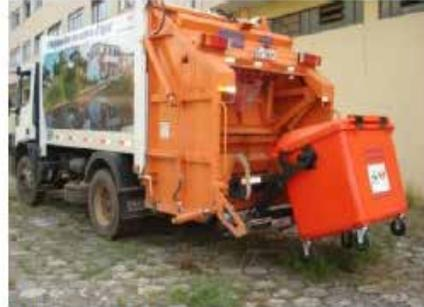
**Figura 4:** Caminhão compactador em ação e container
