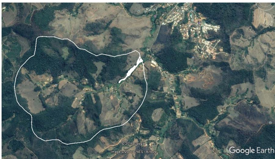
Figura 1: Área demarcada do espelho d'água e do barramento dentro da bacia de contribuição.
