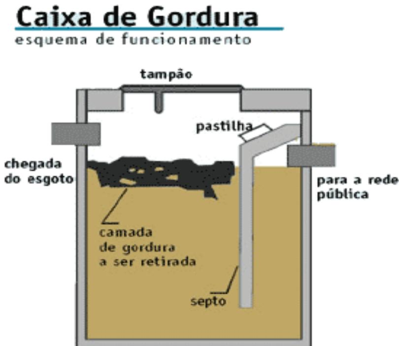
Figura 1: Desenho esquemático do funcionamento de uma caixa de gordura.
