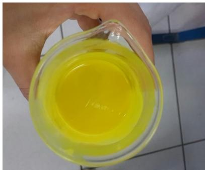
**Figura 02:** Tinta a base de resina acrílica com extração de açafrão.
