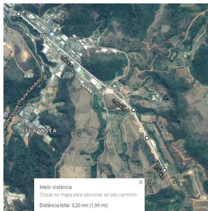
Figura 1 - Mapa Via satélite da UFV (a) Traçado da tubulação de coleta e retorno do esgoto. Fonte: Google Maps (ADAPTADO) (b) Comprimento da tubulação de retorno principal. Fonte: Google Maps.
